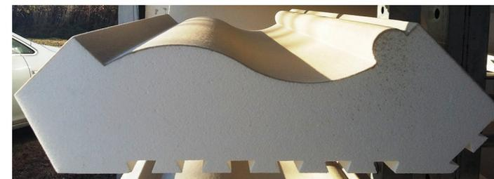
La foto a sinistra rappresenta un modello di cornice sotto gronda formato cassero utilizzato nel cantiere per la costruzione del frantoio di olive nel borgo di Valnogaredo nel comune di Cinto Euganeo (PD). Nella parte inferiore si possono notare le code di rondine che favoriscono l'incastro del calcestruzzo.
